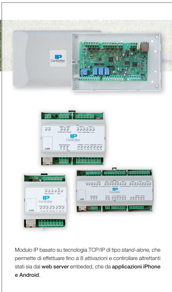
Modulo IP basato su tecnologia TCP/IP di tipo *stand-alone*, che permette di effettuare fino a 8 attivazioni e controllare altrettanti stati sia dal **web server embedded**, che da **applicazioni iPhone e Android**.
